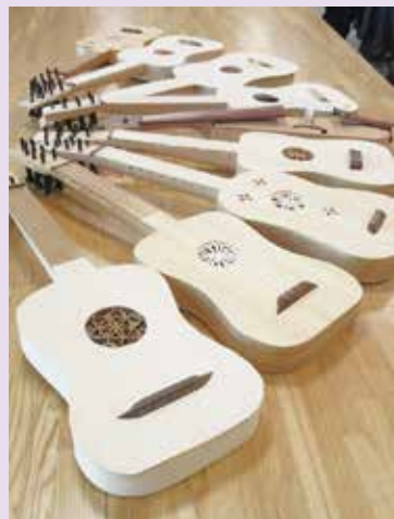
受講生製作のギター 基本のギターサイズ(目安) 全長:70cm 弦長:50cm 幅:20cm
